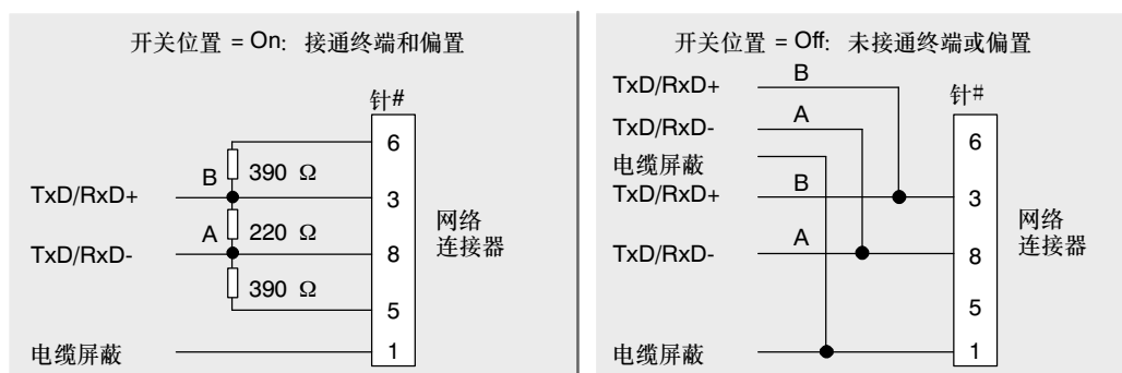
图11-5 网络电缆的偏置和终端
