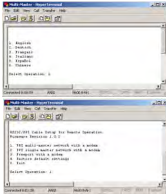
图7-40 超级终端语言选择和RS-232/PPI电缆设置。
